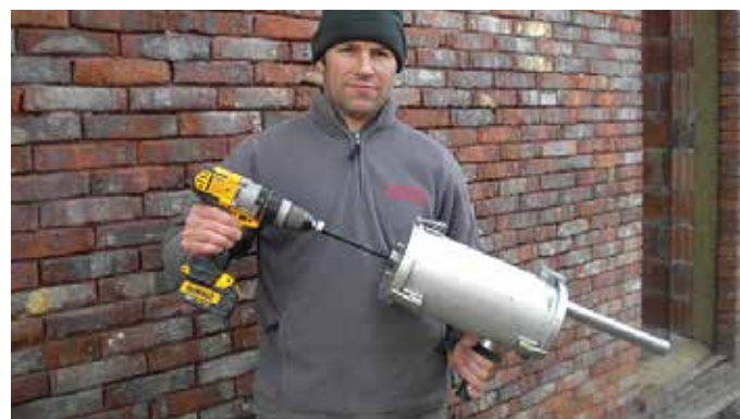
Foto 6: machinaal spuitpistool zonder pomp (bron: Uniconstruct)
