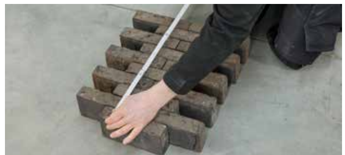
Foto 8: bepaling gemiddelde dikte van de baksteen
